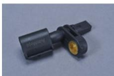
Czujnik prędkości obrotowej koła (ABS lub ESP)
